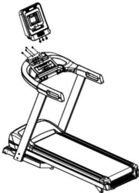
Шаг 4: Установите и закрепите крышки на раме, используя винты 4 \* 16. Пожалуйста, затяните все болты еще раз.
