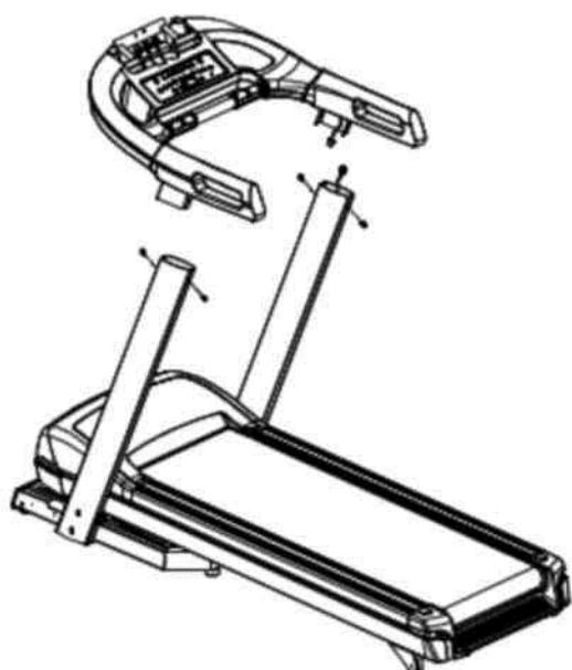
Шаг 3: Подключите провод консоли к сигнальному проводу дисплея. Закрепите дисплей винтами M8x15 с внутренним шестигранником.
