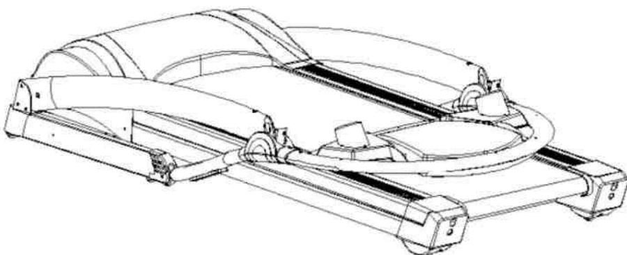
Шаг 2: Поднимите стойки как показано на рисунке и закрепите болтами M8\*50 болтов, не затягивая их. Обратите внимание на укладку кабеля.
